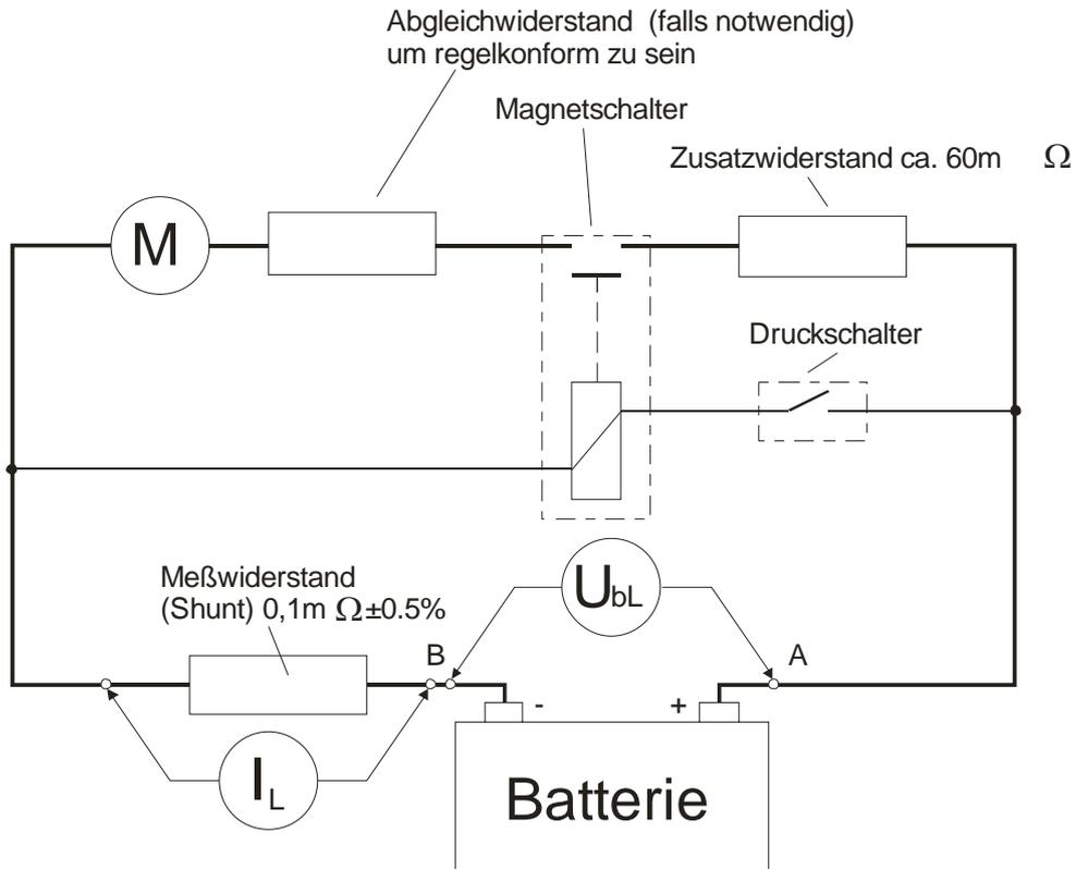
Abb. 3: Prüfung bei niedrigem Strom – Anordnung mit Magnetschalter
