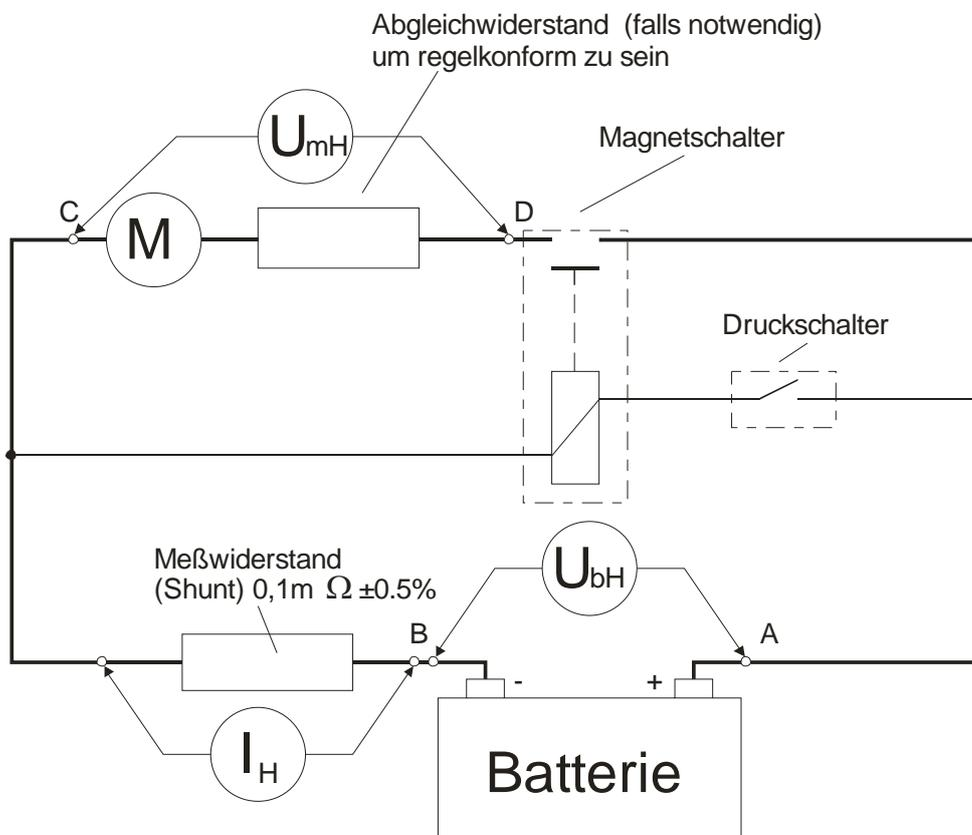
Abb. 4: Prüfung bei hohem Strom – Anordnung mit Magnetschalter
